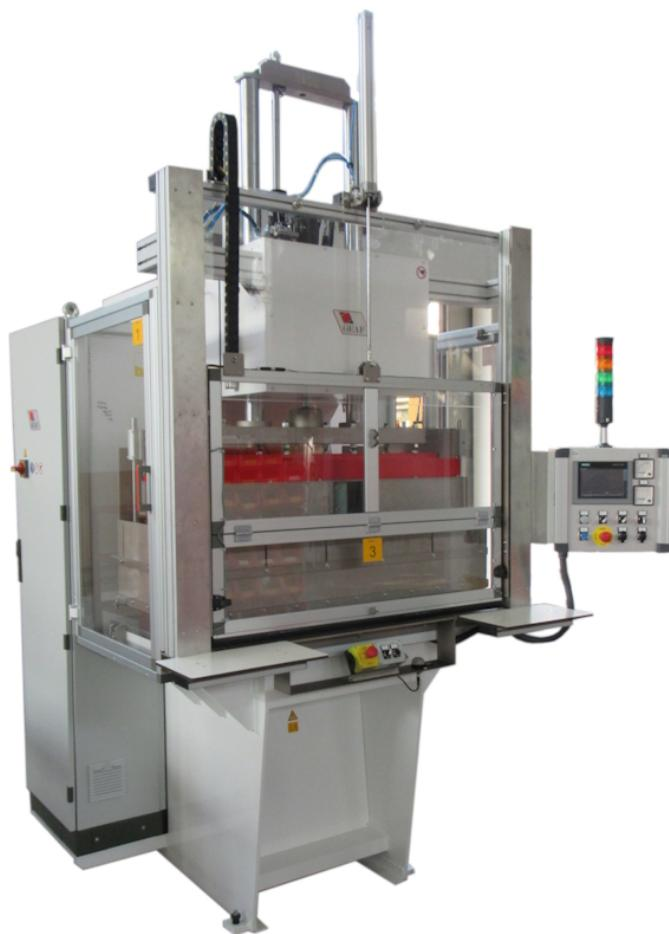
Zur Herstellung von 2D- oder 3D-Sonnenschutzblenden aus PVC-Folie
