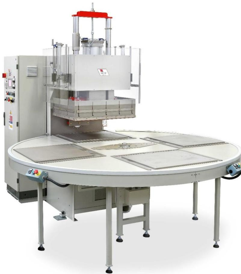
Für die Herstellung von Drainagebeuteln aus calandriertem PVC-Film
