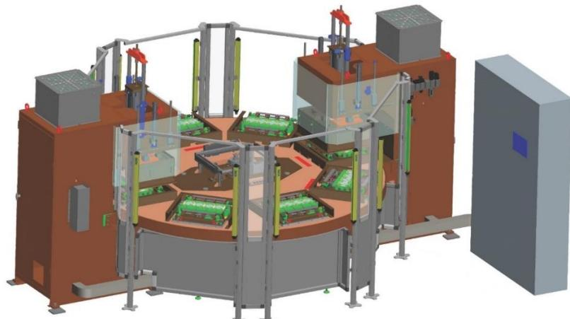
Pour la production de filtres pour le sang de type flexible en film PVC
