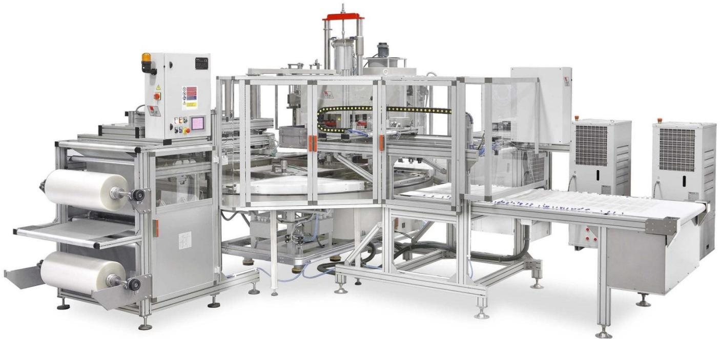
Für die Herstellung von Drainagebeuteln aus calandriertem PVC-Film
