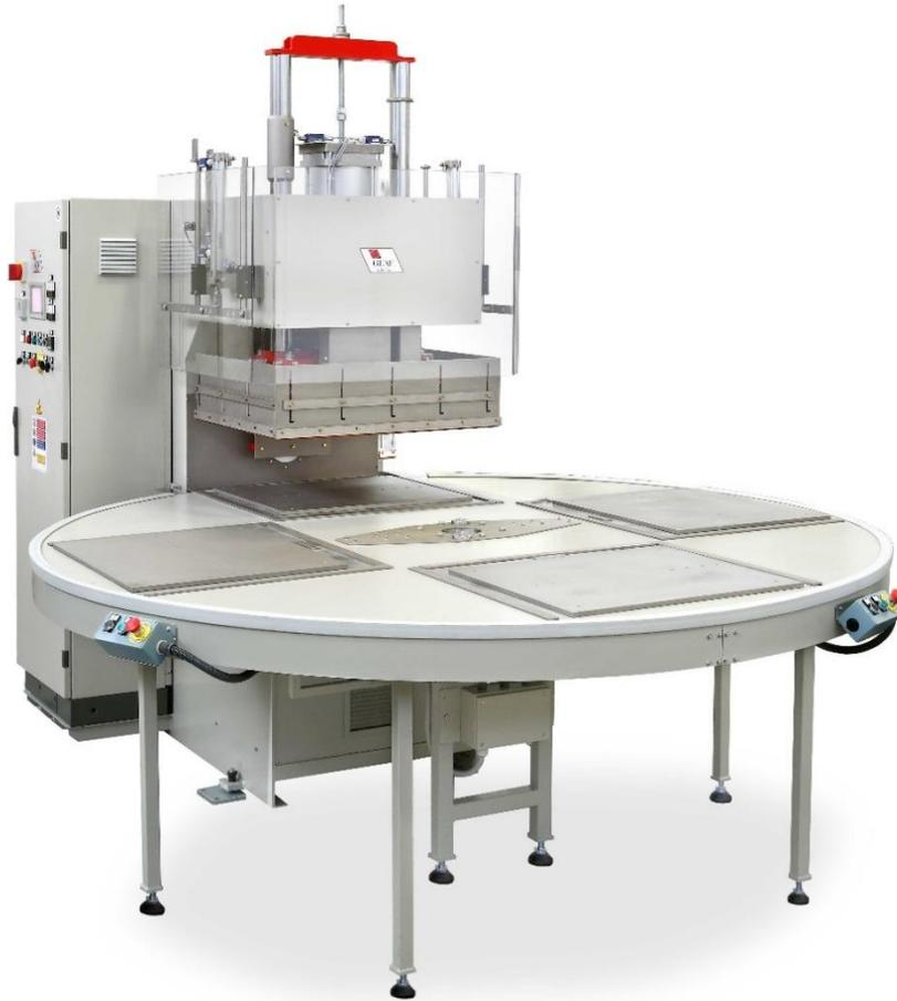
Für die Herstellung von Drainagebeuteln aus calandriertem PVC-Film
