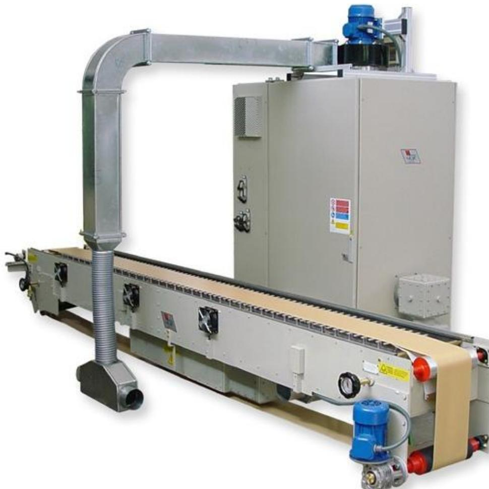
Sèche-linge à radiofréquence pour le séchage de la colle vinylique, déposée sur les dos des livres, à installer sur les lignes de reliure
