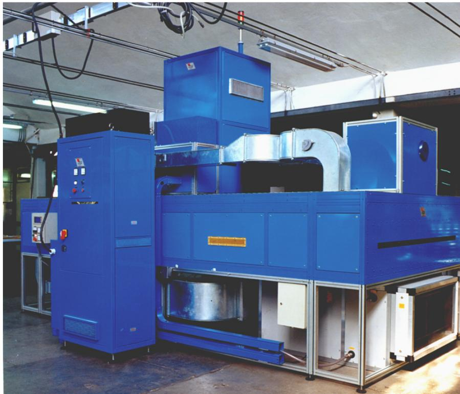
**Tunnel bimodulo, a radio frequenza, per l'essiccazione ad alta velocità di fili tessili, dopo imbozzimatura, su linee di stiro-incollaggio**
