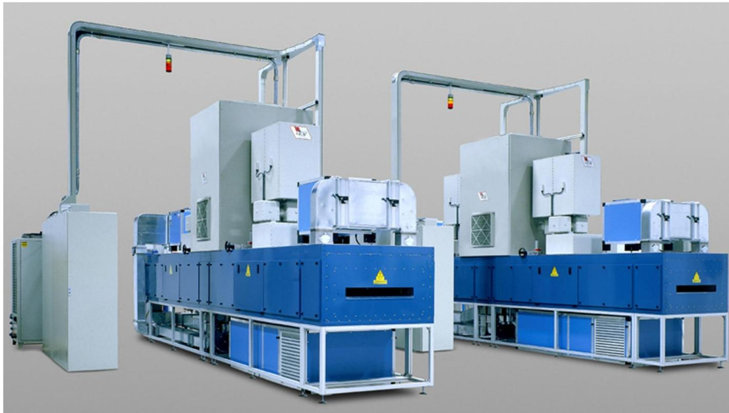
Tunnel bimodulaire, à haute fréquence, pour le séchage de colles et résines, pour l'adhésion sur fils et cordes de gros titre
