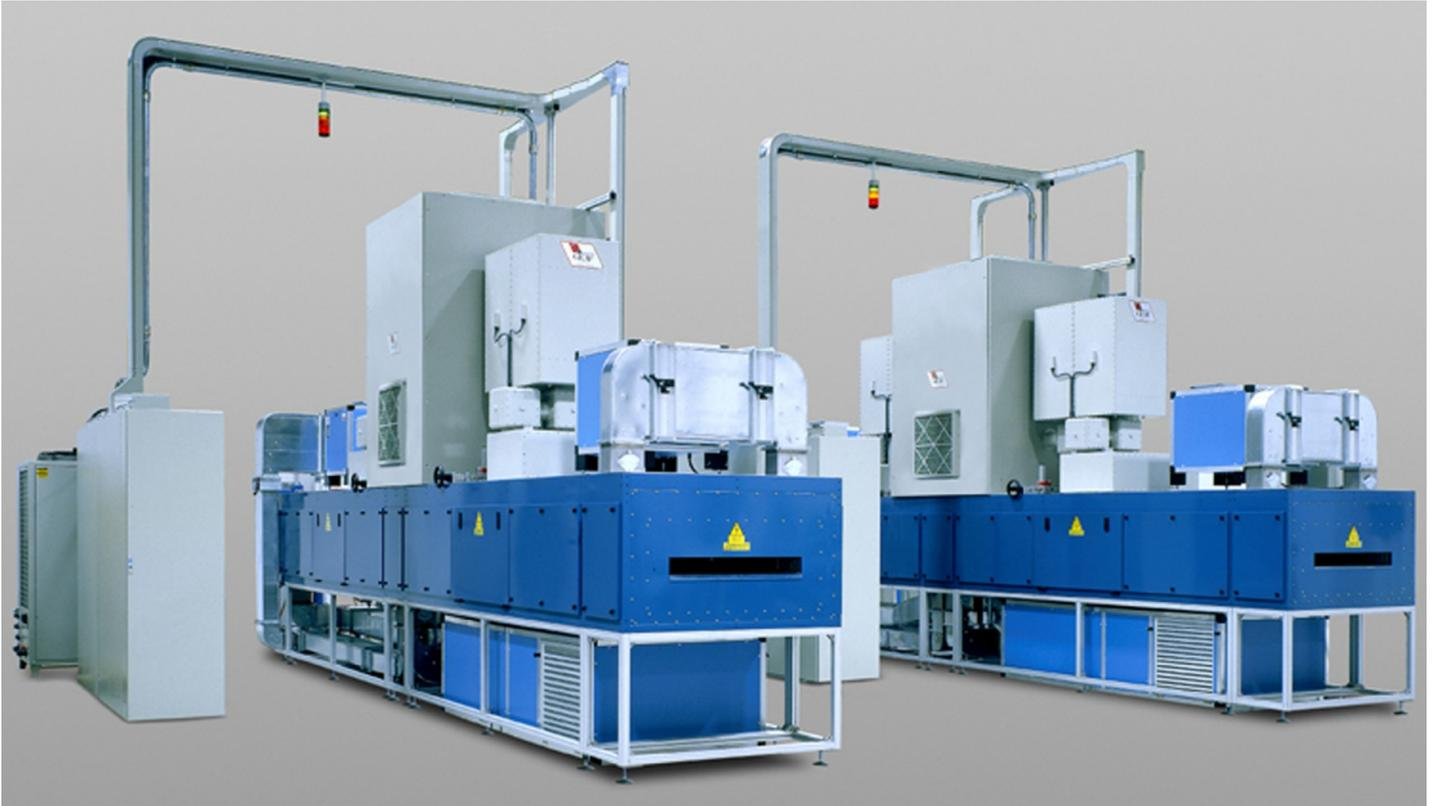
**Bimoduliger Tunnel mit Hochfrequenz für die Trocknung von Klebstoffen und Harzen, zur Verfestigung von dickeren Drähten und Seilen**
