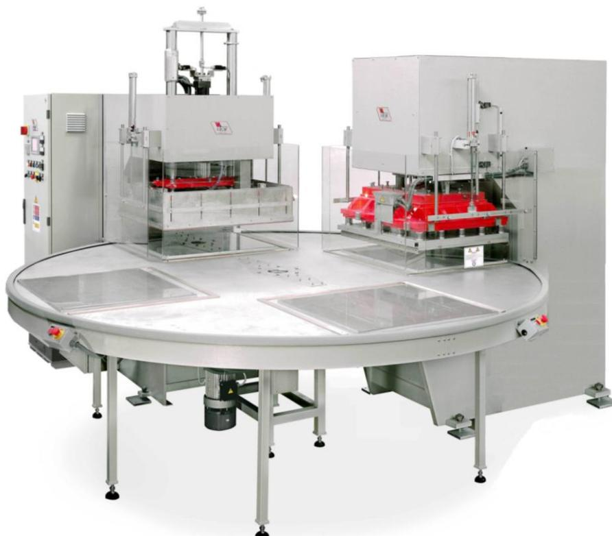
Zur Herstellung von Blistern aus PET-G, A-PET, PET-GAG und in einigen Fällen R-PET
