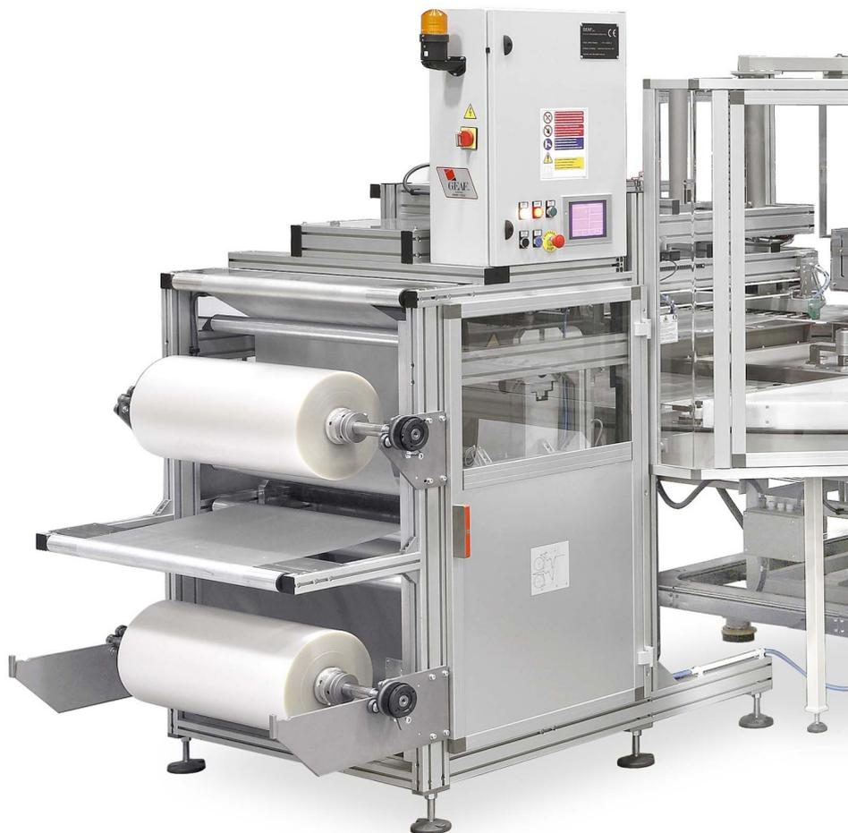
Per il carico automatico da bobina di 1 o 2 fogli di PVC sulle stazioni della tavola rotante
