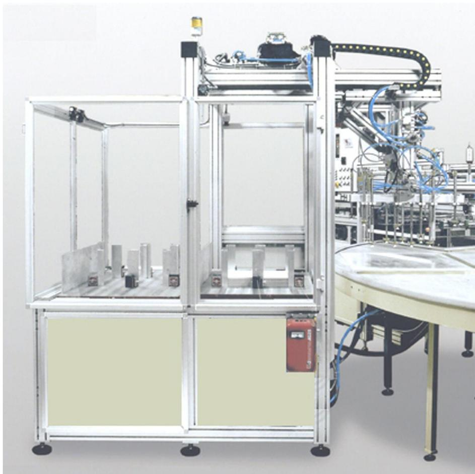
Pour le chargement automatique de feuilles thermoformées, de feuilles pré-découpées ou de cartons pré-découpés, sur les stations de la table tournante
