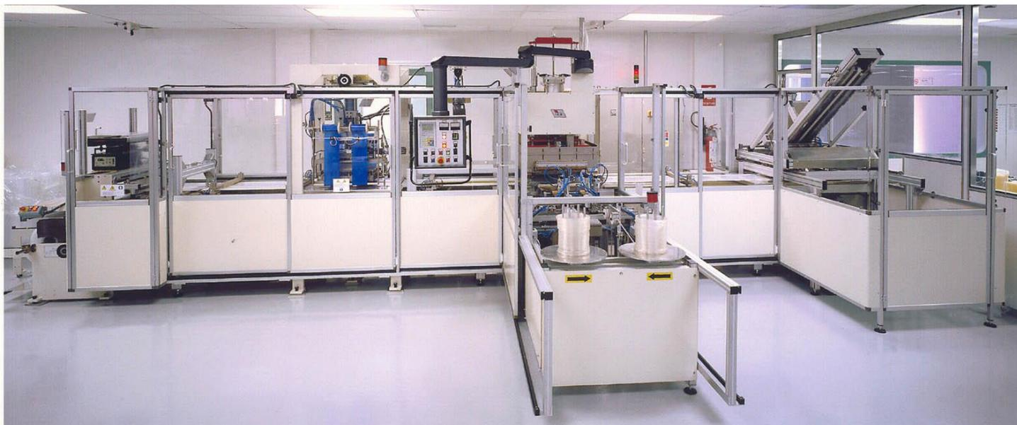
Für die Herstellung von Beuteln für Lösungen aus extrudierter PVC-Folie
