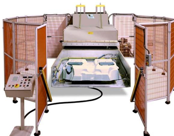
Pour la soudure de renforts sur tapis de voiture thermoformés
