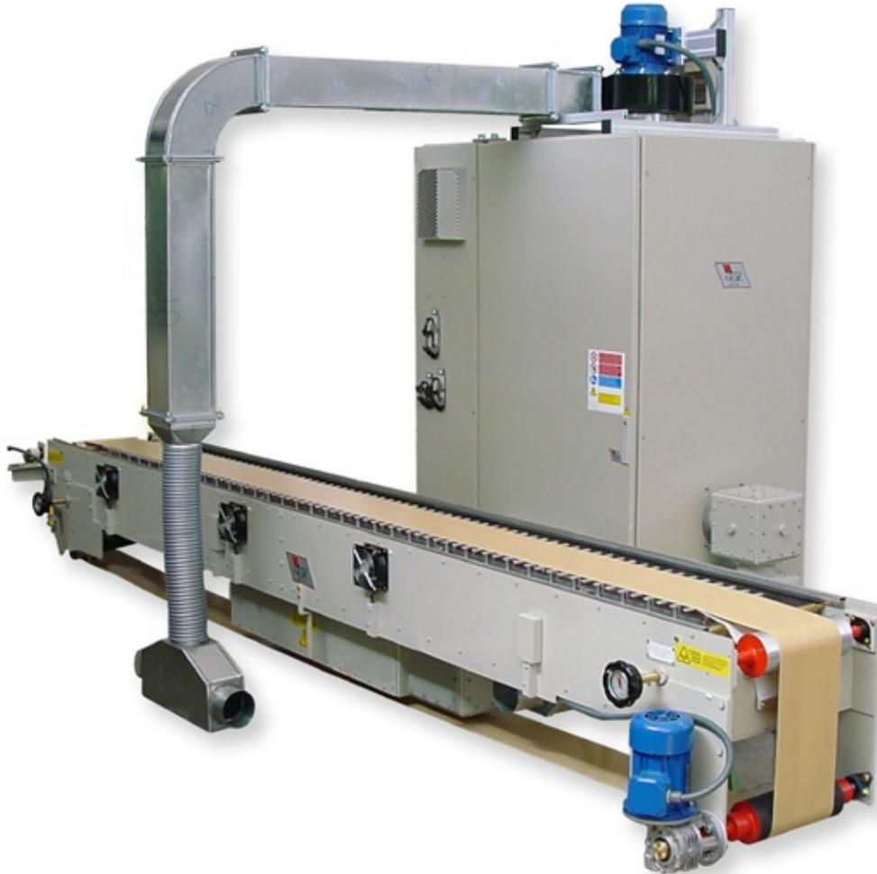
Hochfrequenz-Trockner zum Trocknen von Vinylkleber, der auf den Buchrücken aufgetragen wird, zur Installation in Buchbindelinien
