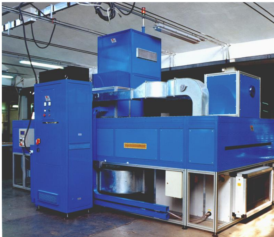
Tunnel bimodulaire à radiofréquence pour le séchage haute vitesse des fils textiles, après mercerisage, sur des lignes de repassage-collage
