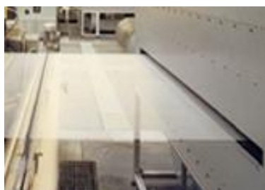
Tunnel bimodulaire à radiofréquence pour le séchage haute vitesse des fils textiles, après mercerisage, sur des lignes de repassage-collage
