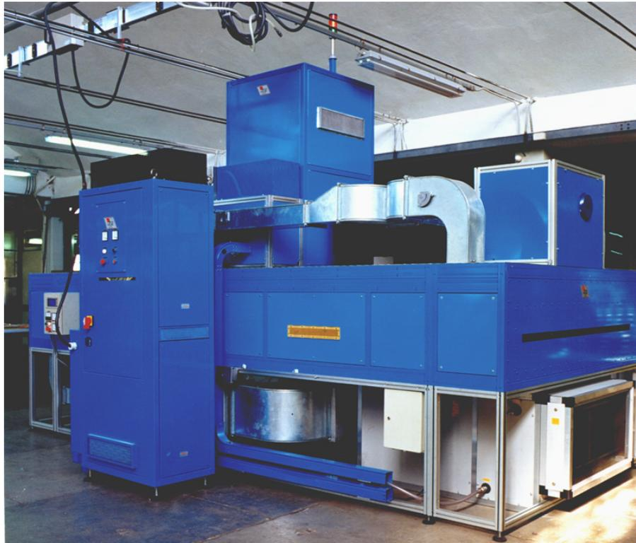
**Bimodularer Hochfrequenz-Tunnel zum Hochgeschwindigkeits-Trocknen von Textilfäden nach der Imbozzimatura, auf Linien zum Bügeln und Kleben**
