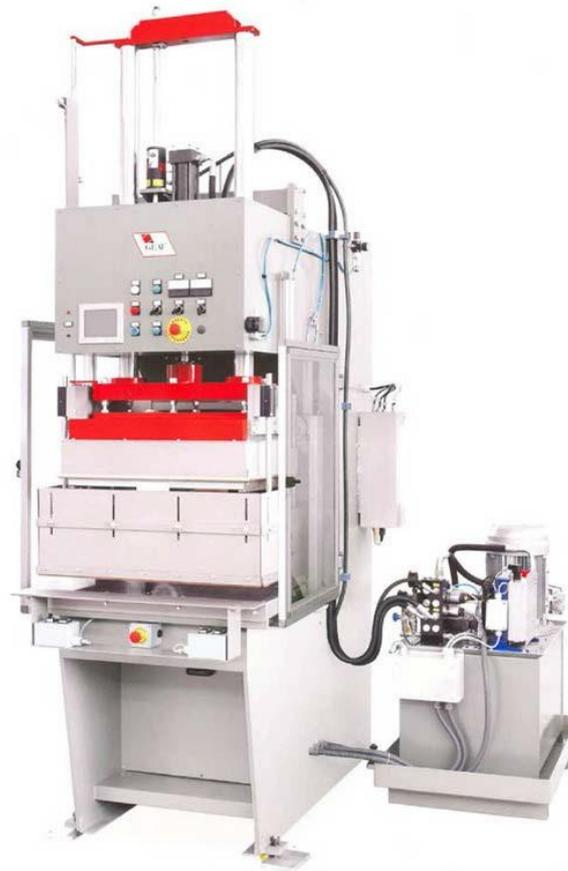
Zur Herstellung von 2D- oder 3D-Sonnenschutzblenden aus PVC-Folie
