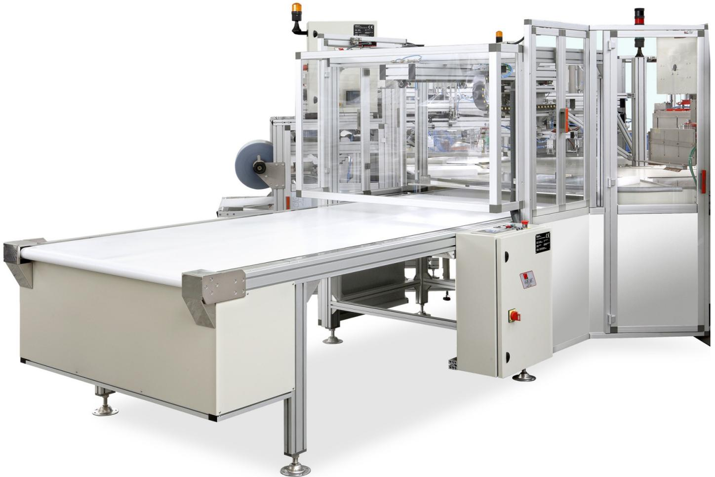
Für das automatische Entnehmen der Produkte von der Drehtischstation und das Abladen auf ein Akkumulationsband
