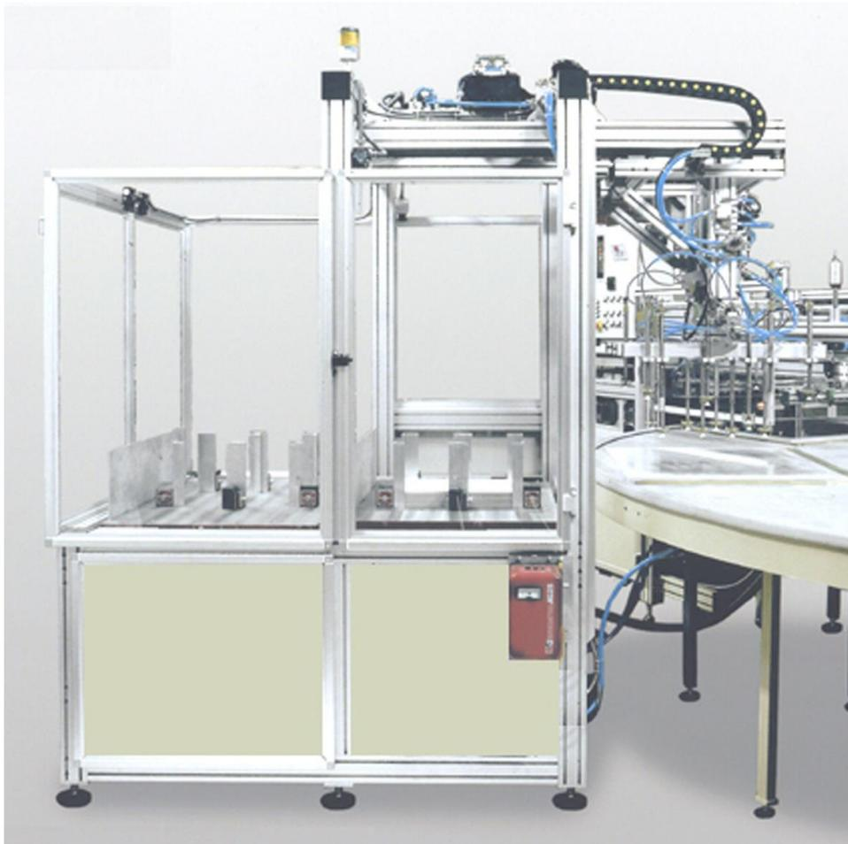
Pour le chargement automatique de feuilles thermoformées, de feuilles pré-découpées ou de cartons pré-découpés, sur les stations de la table rotative
