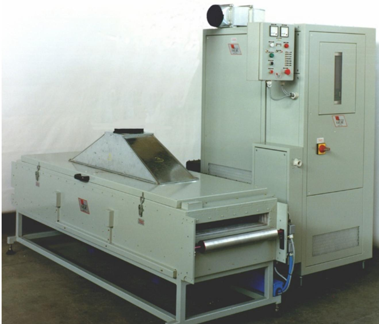
**Essiccatoio a radio frequenza per l'essiccazione di colle a base acqua, su linee di produzione in continuo di buste e moduli autoimbustanti**
