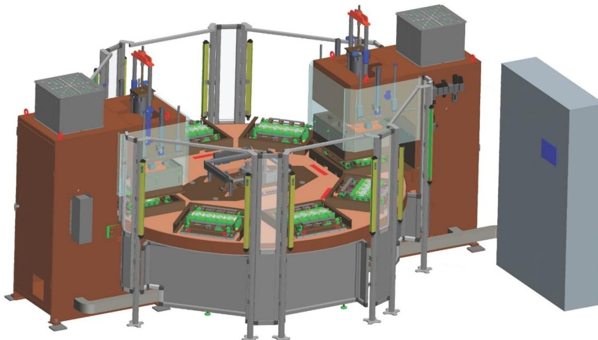
Per la produzione di filtri sangue di tipo flessibile in film PVC
